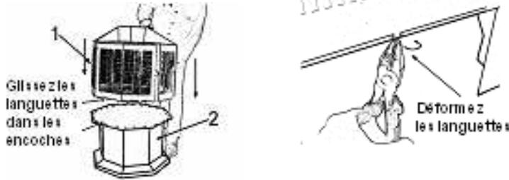
2. Assemblez la cheminée en un morceau et glissez le chapeau sur la partie conique de la cheminée et vissez ensuite celui-ci dans les 2 trous situés au bas du chapeau. Utilisez 2 vis auto perçantes. Relevez ensuite les 4 attaches situées dans le trou du toit à 90 degrés. Placez la cheminée entre ces 4 attaches et vissez les 4 attaches sur la cheminée avec 4 vis auto perçante.
