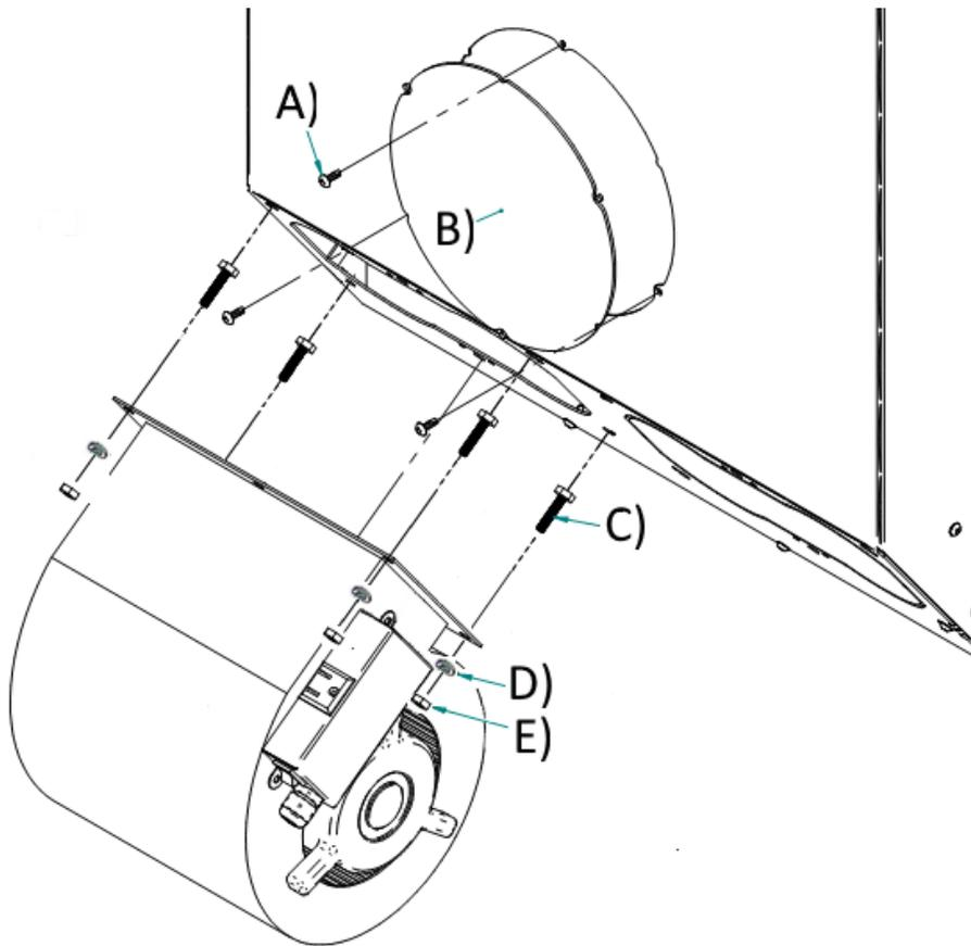
**Étape 1 :** Enlever le panneau d'accès (B) sur le dos de l'appareil en dévissant / desserrant les 3 vis (A). Insérer les 4 boulons (C) à leur endroit désigné, à l'intérieur du boîtier de ventilation, en passant la main à travers de l'ouverture d'accès et en prenant soin d'orienter la partie filetée des boulons vers le bas. Visser le ventilateur au poêle avec les 4 rondelles de blocage (D) et les 4 écrous (E) fournies avec l'ensemble du ventilateur
