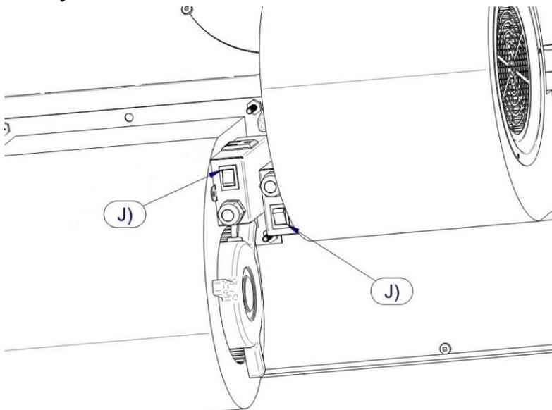
**Étape 1 :** Il est possible changer la vitesse du ventilateur entre la haute et la basse en alternant la position des interrupteurs (J). La position des interrupteurs telle que montrée dans l'image adjacente devrait correspondre à la basse vitesse.
