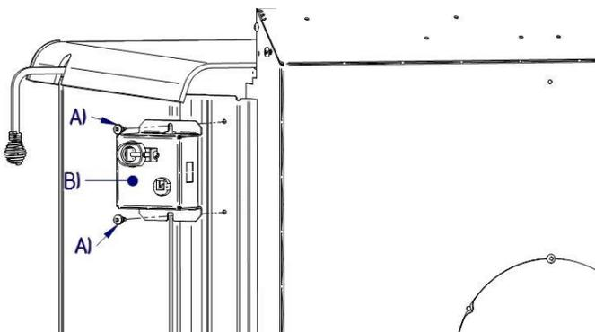
**Étape 2 :** Installer la boîte de jonction du thermodisque (B) du ventilateur en le vissant à l'appareil avec les vis (A) (incluses). La boîte de jonction du thermodisque doit être placée sur le coin arrière gauche (voir image adjacente). Connecter ensuite la fiche de la boîte de jonction du thermodisque à la prise d'alimentation électrique
