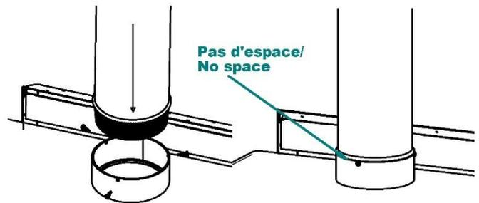
4. Visser la section de tuyau sur le collet du poêle avec un minimum de trois vis dans les perforations faites à cet effet.
