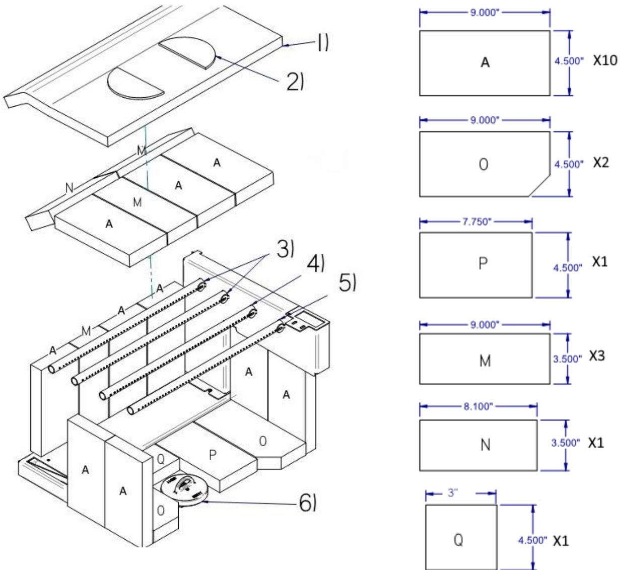
*Liste de pièces et configuration des briques de la chambre à combustion*
