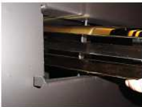
Pour ouvrir les persiennes, soulevez le côté droit et placez-les perpendiculairement à l'appareil. Soulevez et retirez-les.
