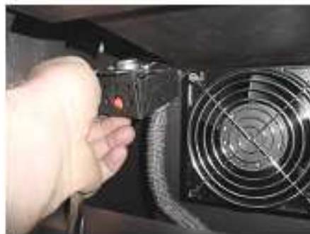
Un boulon de 3/16 déjà soudé à l'intérieur permet de fixer la boîte du thermodisque. Deux trous dans le côté gauche du foyer sont prévus pour sortir le fil (un connecteur est obligatoire).
