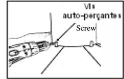
Pour l'installation de la grille, glisser le manche de la grille autour du tuyau. Prendre la poignée et faire glisser les rainures de celle-ci dans les rainures du manche de la grille. Utiliser la vis située au bout de la poignée pour resserrer la grille et l'ajuster afin de prévenir une rotation de la grille.
