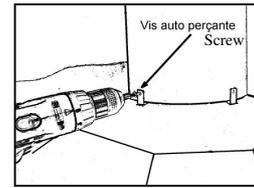
Soulever à 90 degrés les 4 attaches situées au sommet du toit. Insérer la cheminée à l'intérieur des attaches et fixer la cheminée en vissant les 4 vis (incluses) dans les trous des attaches.
