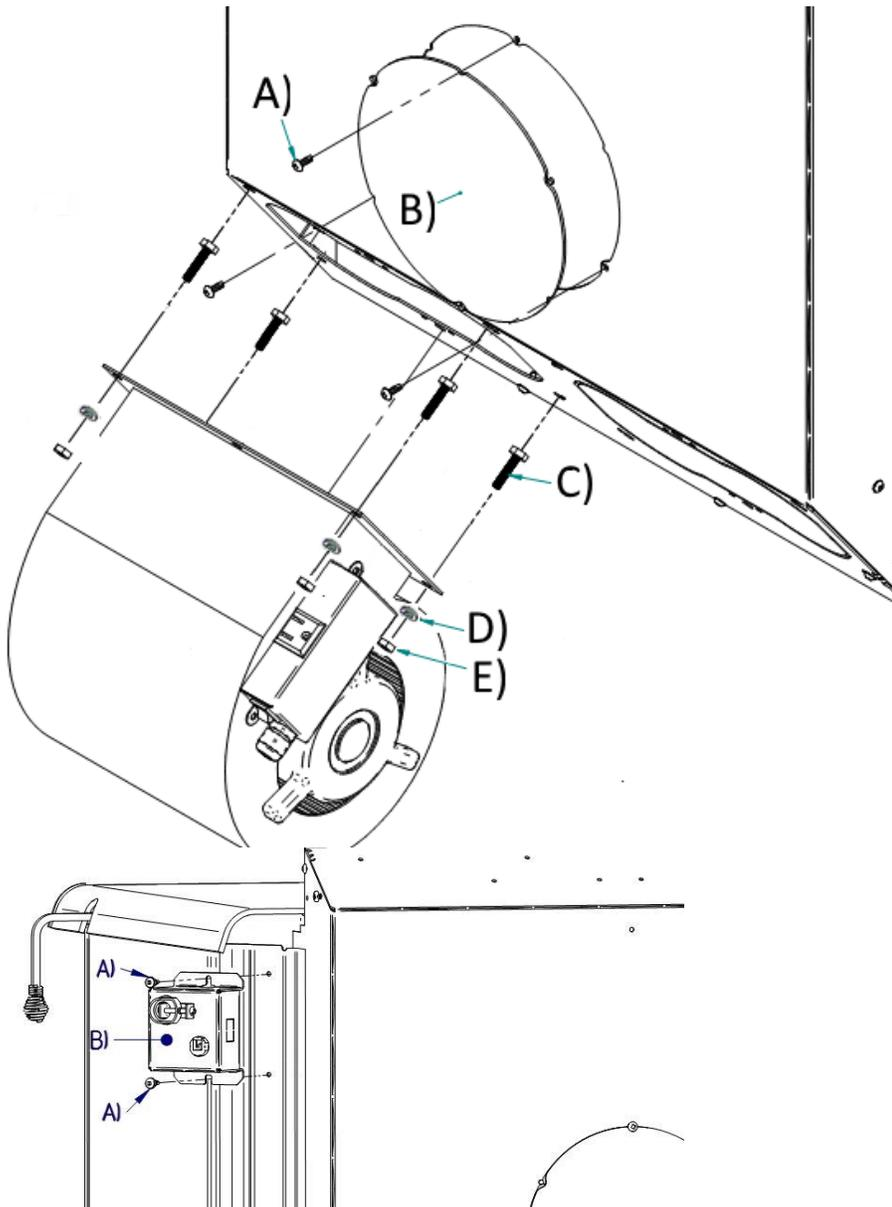
**Étape 1 :** Enlever le panneau d'accès (B) sur le dos de l'appareil en dévissant / desserrant les 3 vis (A). Insérer les 4 boulons (C) à leur endroit désigné, à l'intérieur du boîtier de ventilation, en passant la main à travers de l'ouverture d'accès et en prenant soin d'orienter la partie fileté des boulons vers le bas. Visser le ventilateur au poêle avec les 4 rondelles de blocage (D) et les 4 écrous (E) fournies avec l'ensemble du ventilateur
